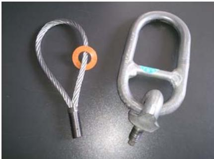
**Bild: Seilschleufe bzw. HD-Abheber – Laststufe beachten**
